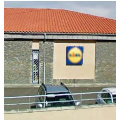
Revêtir une structure standard en parpaing de ciment ou de béton d'un parement de pierre est une solution possible, car plus économique que la maçonnerie en masse homogène. (Vaucluse et Pyrénées-Orientales, image récupérée sur Google-Map)
