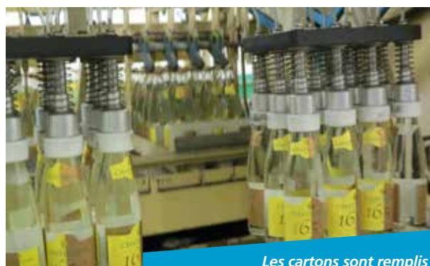
Les cartons sont remplis automatiquement par cette machine
