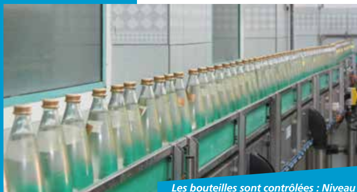
Les bouteilles sont contrôlées : Niveau de remplissage, présence de l'étiquette
